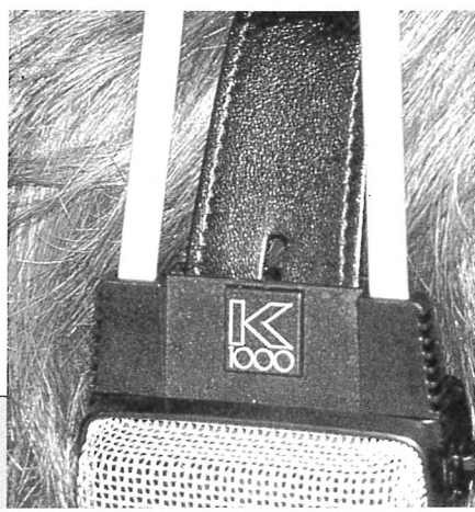
Particolare dell'elegante sopratesta in pelle: l'autoregolazione è garantita dagli attacchi elastici rientranti.
